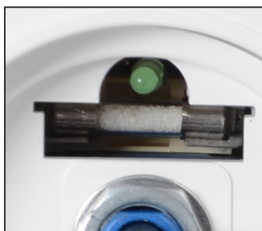
Podważ śrubokrętem i wyjmij bezpiecznik / Pull out with the screwdriver and take off the fuse
